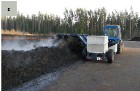
Joonis 4. Kompostiauna segamine: a – eestlaaduriga, b – kopp-purustiga ALLU, c – järelveetava pööriliga COMPOST and WASTE Technology ST-300, d – liikurpööriliga BACKHUS
